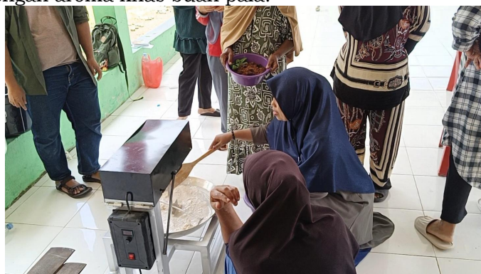
Gambar 6. Proses pengadukan dodol pala menggunakan mesin pengaduk
