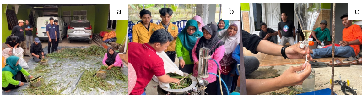
Gambar 2. Praktik penyulingan (a) pencacahan serai wangi, (b) proses loading bahan baku ke dalam ketel penyulingan, (c) proses penyaringan minyak serai wangi yang dihasilkan dari praktik penyulingan oleh peserta.
