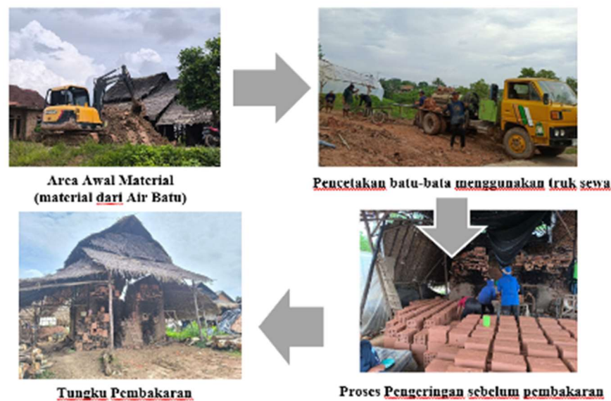
Gambar 3. Alur aktifitas produksi batu-bata
