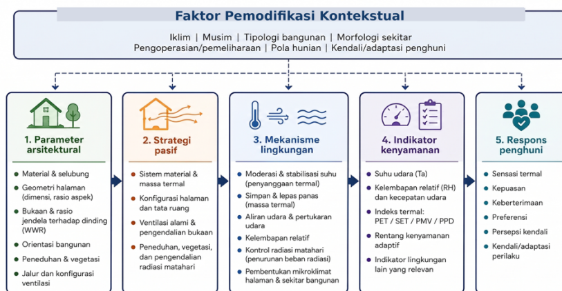
Gambar 4. Kerangka kinerja bangunan peka iklim yang menghubungkan parameter arsitektural, strategi desain pasif, mekanisme kinerja lingkungan, indikator kenyamanan, dan respons kenyamanan penghuni.
