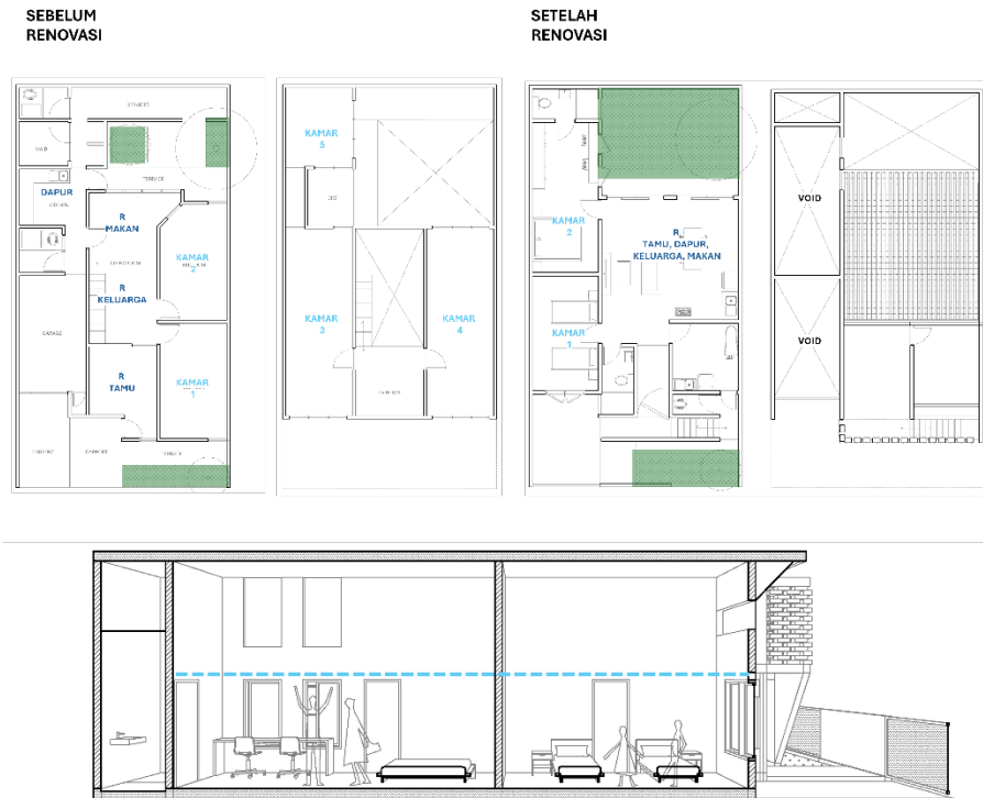
Gambar 3. Pengurangan jumlah ruangan dalam renovasi
