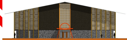
Gambar 3. 11 Tampak Utara GOR Saparua dengan Pengulangan Struktur Kolom "V" Terbalik dan Kanopi Nonkonvensional
