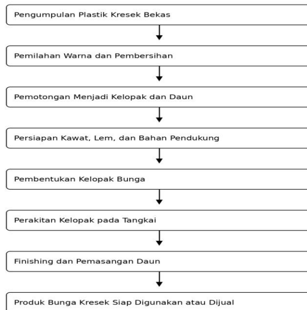
Gambar 1. Diagram Alir Proses Pembuatan Bunga dari Plastik Kresek Bekas
