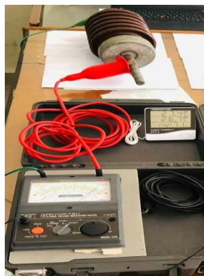
Gambar 3. Konfigurasi Peralatan Pengujian Tahanan Isolasi Isolator Porselin
