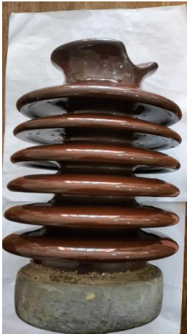
Gambar 2. Isolator Porselin yang Digunakan
