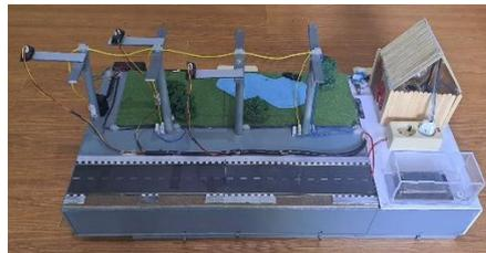
Gambar 11. Prototipe Penentu Titik Lokasi Gangguan (*Fault Locator*) berbasis Mikrokontroler
