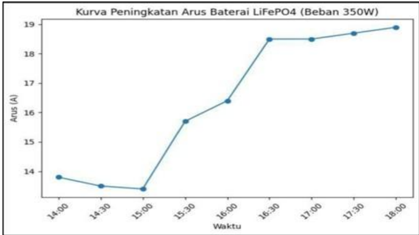
Gambar 5. Kurva Peningkatan Arus Baterai LiFePO 4 Saat Pengosongan
