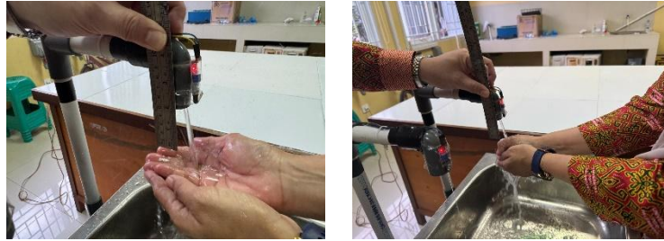
Gambar 17. Pengujian Sensor Infrared Pada Pipa Air
