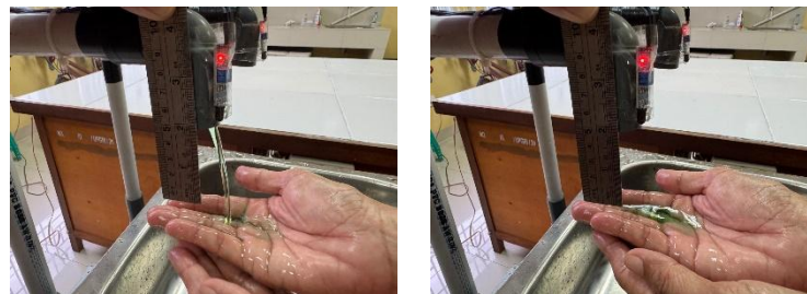
Gambar 18. Pengujian Sensor Infrared Pada Pipa Sabun
