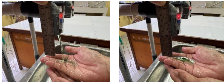
Gambar 18. Pengujian Sensor Infrared Pada Pipa Sabun
