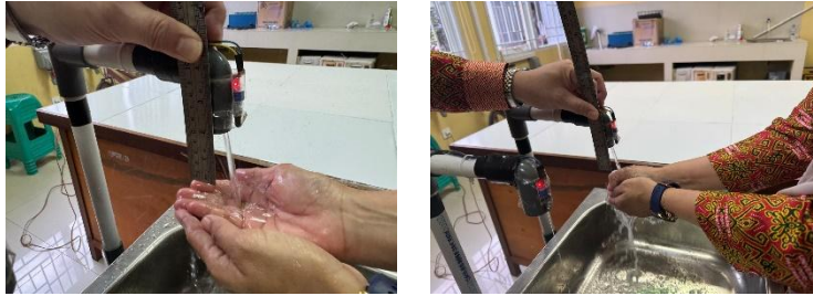
Gambar 17. Pengujian Sensor Infrared Pada Pipa Air
