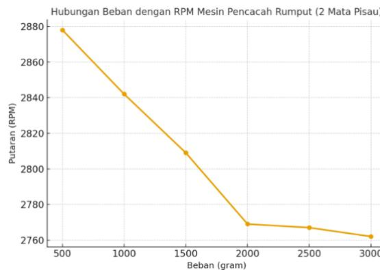
**Gambar 11. Grafik Hubungan Antara Beban (gram) dengan Putaran Mesin (RPM)**
